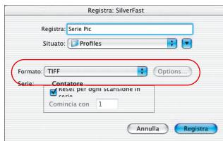
**Formato file:** Sotto «Formato» si può ancora una volta scegliere tra diversi formati per i files. Un quadro di insieme si ricava dalla tabella già riportata. Per i formati «JPEG» e «DCS» ulteriori parametri si possono impostare attraverso il pulsante «Opzioni...».
