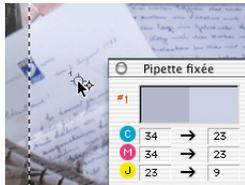
En appuyant sur la touche Maj et en cliquant sur l'image, le densitromètre peut fixer jusqu'à quatre points de mesure à un endroit quelconque de l'image. Pour supprimer un point de mesure, recliquez sur le point à désactiver en maintenant la touche Maj enfoncée. Si un point de mesure est fixé, un croisillon numéroté apparaît à cet endroit de l'image.
