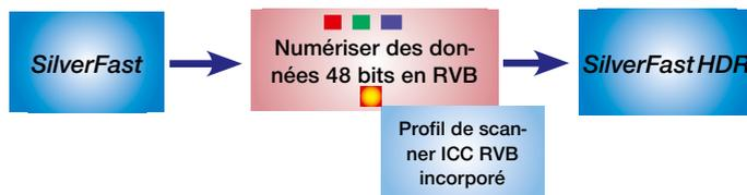
Incorporation d'un profil de scanner dans le fichier RVB 48 bits
