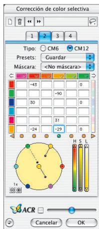
La nueva corrección de color selectiva de *SilverFast*, a partir de la versión 6, dispone de hasta cuatro capas. En cada capa se pueden llevar a cabo correcciones de color independientes, incluso con máscaras. Así por ejemplo, se pueden transformar sin problema cuatro objetos con el mismo color original en cuatro colores nuevos diferentes. Así se pueden realizar correcciones de color complejas de forma fácil y simple.
