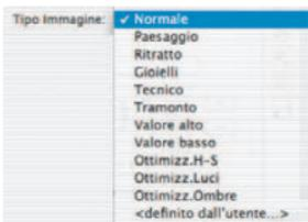
Sotto «Tipo Immagine» effettuate la scelta appropriata per configurare la «Auto-Regolazione», in modo che il controllo automatico dell'immagine sappia come ottimizzare l'immagine stessa. Immediatamente dopo la selezione di «Tipo Immagine», viene applicata la «Auto-Regolazione» automatica (Osservate come l'immagine verrà ottimizzata)
