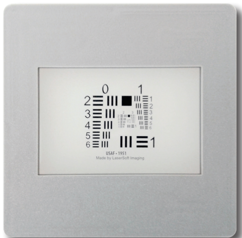
Target de Resolución de 35mm (USAF 1951)
