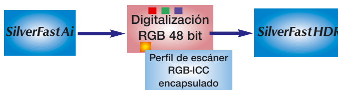
Encapsulación de un perfil de escáner en los datos RGB 48 bit.
