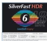
*SilverFastHDR* trabaja sin escáner y es una herramienta para la optimización de imágenes ya existentes. Se pueden tratar todos los archivos de imágenes RGB con una profundidad de color de 24 bits (8 bits por canal) o 48 bits (16 bits por canal). Los archivos pueden ser en formato Tiff o JPEG.
