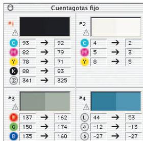
Los valores del punto de medida fijado de la pipeta no se mostrarán en la ventana normal del densitómetro sino en una ventana propia. Esta ventana se adapta al número de puntos de medida, es decir, su tamaño se adapta al número de puntos fijados y al modo de color especificado (RGB, CMYK, Gris, etc.).
